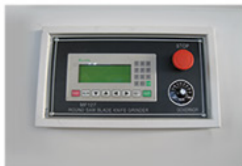
کنترلر PLC با ورودی تعداد دندانه ها و سرعت کار و جهت گردش سنگ و ...
