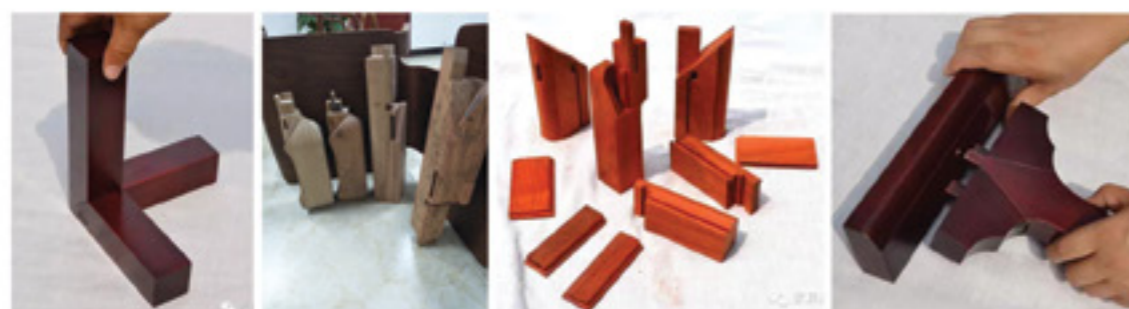
بخشی از توانایی های ماشین در قبال ساخت انواع اتصالات و زبانه ها بر حسب نیاز مشتری
