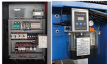
دارای سیستم روغن رسانی هوشمند اتوماتیک
