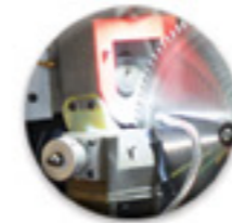
سیستم براده برداری با استفاده از SERVOMOTOR جهت افزایش کیفیت تیز نمودن و کاهش مصرف سنگ = افزایش راندمان
