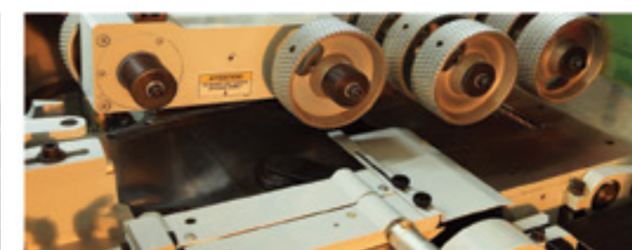
ساختار فنی و داخلی مولدر ۵ موتور
