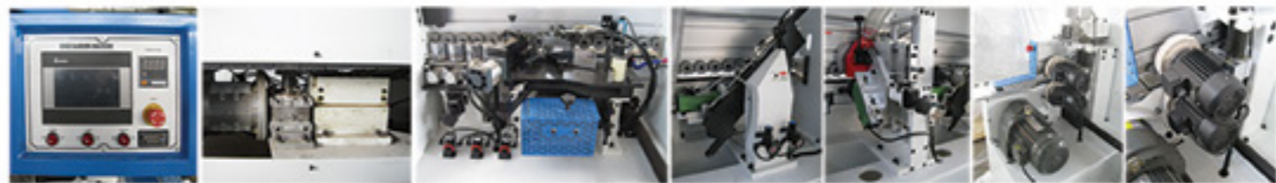
ایستگاه پولیش | دارای گیر بکس موتور نوار نقاله به صورت مجزا | ایستگاه فرز | ایستگاه پرداخت کامل دو موتور های فرکانس | اره ابتدا و انتهای دو موتور دور بالا | سیستم مغزن چسب و برسینگ | دارای گیر بکس مغزن چسب و گیر بکس ایستگاه برسینگ | کنترلر لمسی دارای دماسنج و متر خوان مجزا
